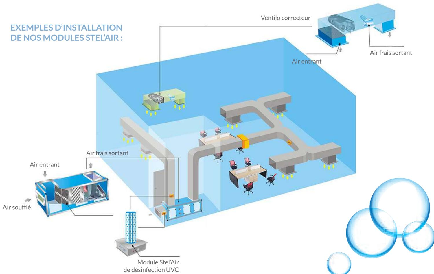
La puissance et le nombre de module seront déterminés par la capacité /volume de la centrale ( $\text{m}^3/\text{h}$ ).
